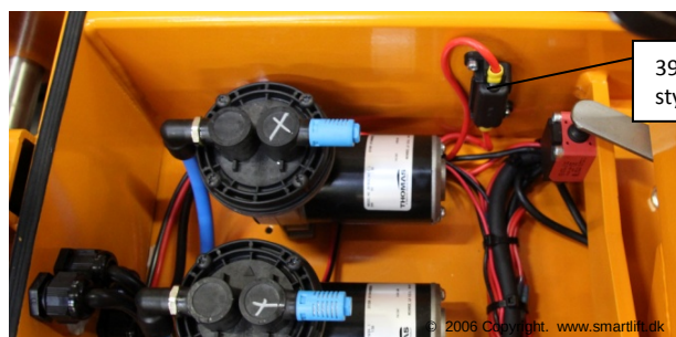
47c Säkring 10 A for motorstyrning
