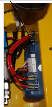
47 b - Säkring 80 A för framdrift
